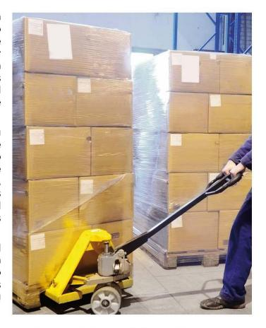
En la posición elevada, la transpaleta con su carga son transportadas y guiadas mediante la barra de tracción. Una vez efectuado el recorrido, la operación de descenso se realiza mediante una palanca situada en la barra de tracción.
