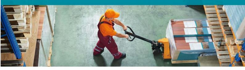
En el transporte y manipulación de cargas, las transpaletas y apiladoras son maquinas utilizadas para transportar y elevar pequeñas cargas.
