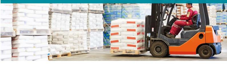
La manipulación de cargas debe efectuarse guardando siempre la relación dada por el fabricante entre la carga máxima y la altura a la que se ha de cargar o de descargar.
