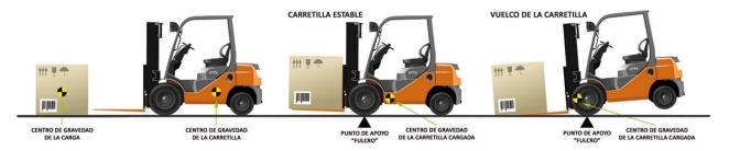
La posición del centro de gravedad de la carretilla cargada, depende principalmente del peso de la carga, de su posición sobre la horquilla y de la altura a la que está situada.
